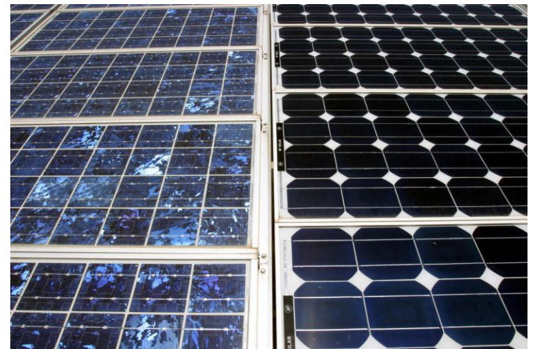
Photo : Panneaux photovoltaïques... ... à gauche : à base de silicium multicristallin ... à droite : à base de silicium monocristallin (©C.Dupont/CEA)
