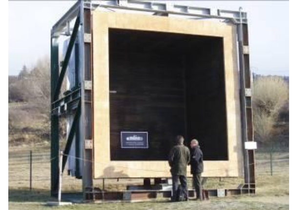
Photo : Récepteur à cavité d'une tour solaire (© CNIM)
